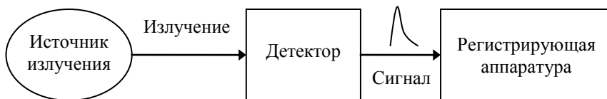
Рис. 1. Функциональная схема лабораторных установок
